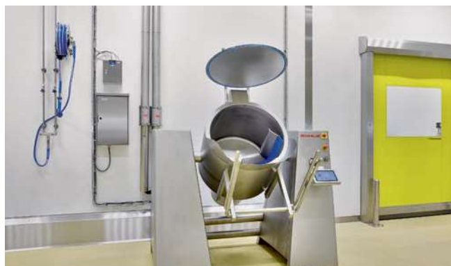
Mit dem 300-Liter-Rühle-Feinkostmischer können unter Vakuum im auf 2°C gekühlten Vorgang Massen vermengt werden. Er verfügt über eine CO 2 -Mantelkühlung.
